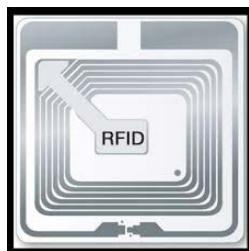
Рисунок 8 – RFID -метка [12, с. 125]
