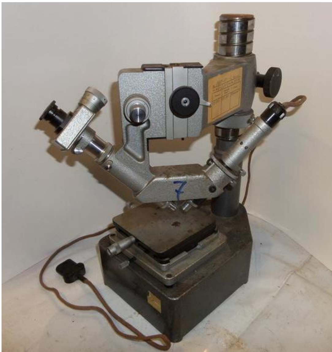
Рисунок 4.1 – Общий вид двойного инструментального микроскопа МИС-11
