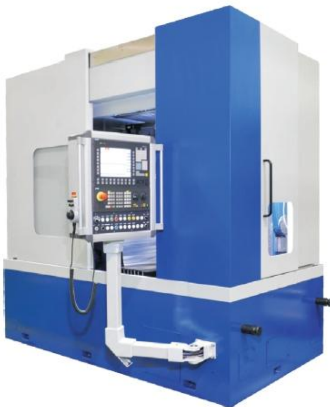
Рисунок 1.10 – Общий вид зубошлифовального станка с ЧПУ QСMT&T YKS7225
