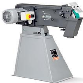
Рисунок 2.8 – Шлифовально-полировальный станок с использованием эмульсии JSSG-10
