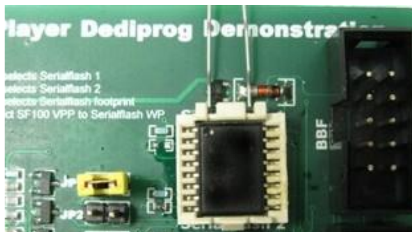
Рисунок 3 – SPI Flash-носитель в специальном сокете
