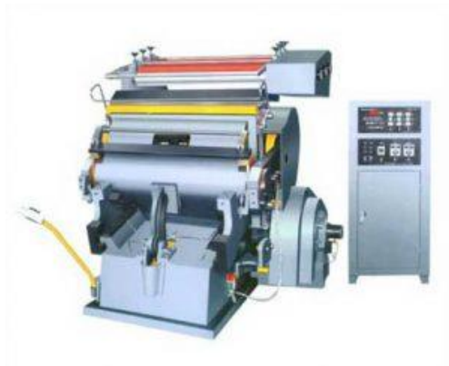
Рисунок 2.7 – Пресс для тиснения и вырубки ТУМК-750
