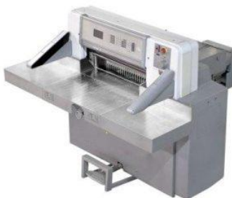
Рисунок 2.6 – Резальная машина POLAR 78
