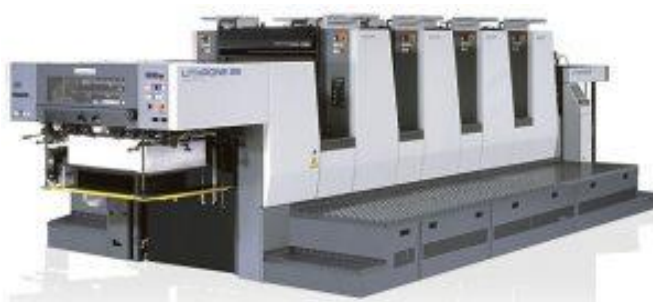
Рисунок 2.5 – Офсетная печатная уф машина KOMORI LITHRONE 428
