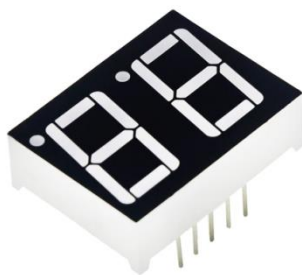
Рисунок 1.19 – внешний вид двухразрядного индикатора
