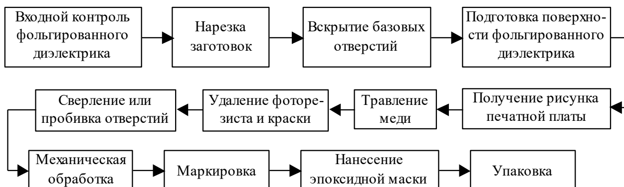
Рисунок 2.1 – Схема типового технологического процесса изготовления ПП химическим методом.
