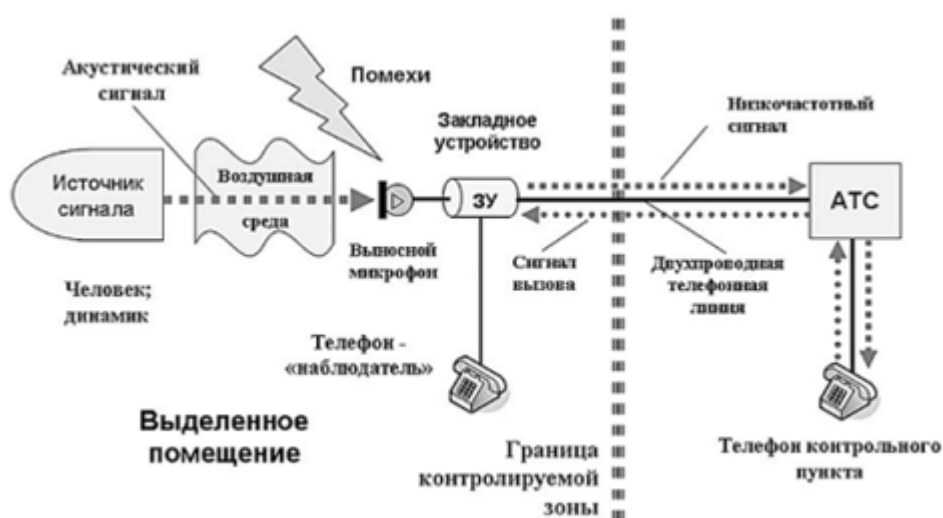
Рисунок 9 - Схема канала перехвата речевой информации с использованием устройств типа «телефонного уха» с передачей информации по телефонной линии на низкой частоте
