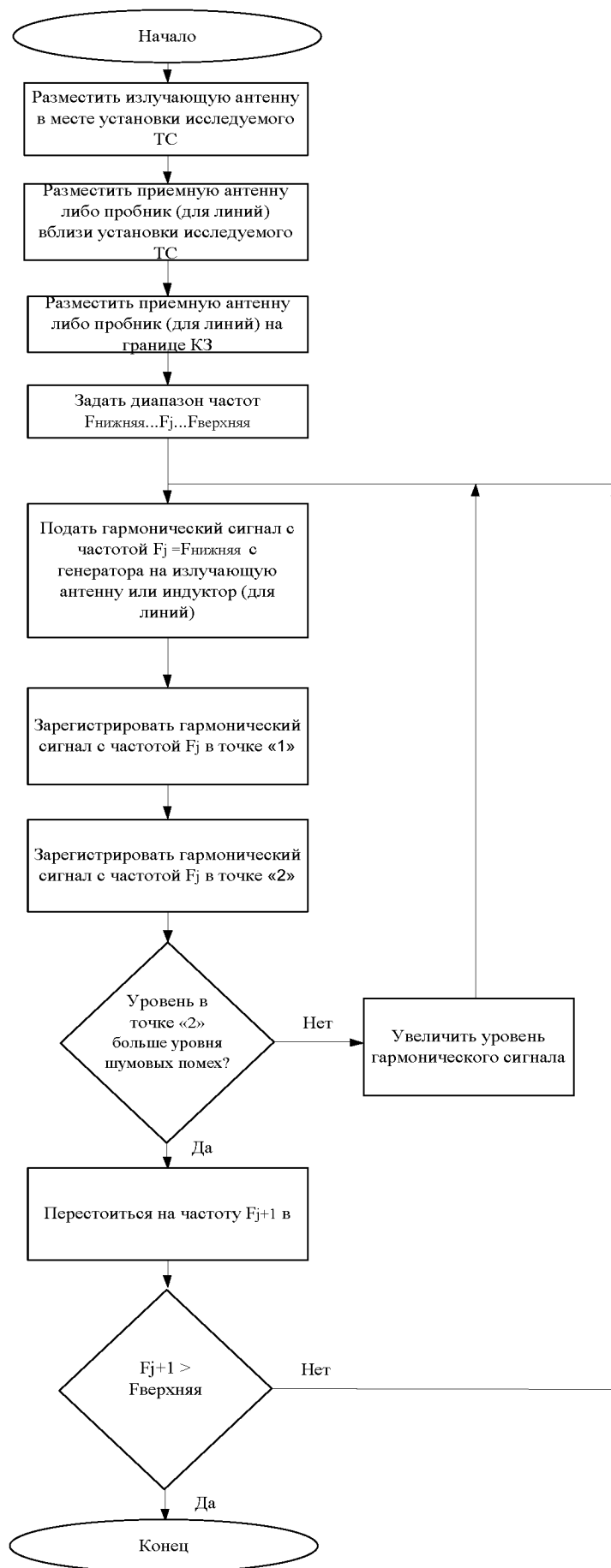
Рисунок 5.1 – Алгоритм измерения затухания
