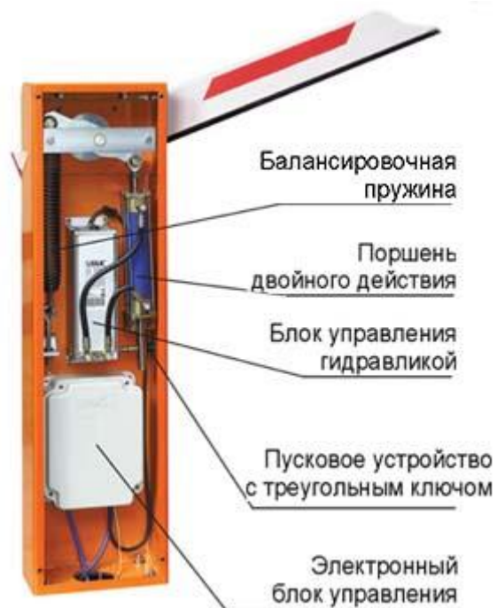
Рисунок 10. Исполнительные механизмы шлагбаума.
