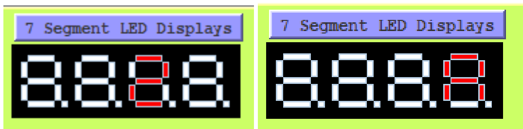
Рисунок 4. Вывод результата на семисегментные индикаторы (получили число 2A)
