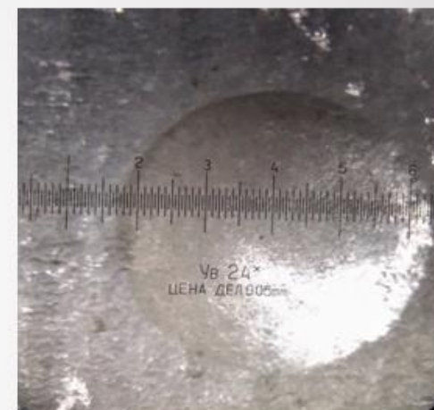
Рисунок 15 – Отпечаток индентора при определении твердости по Бринеллю на стали 30ХМА в состоянии поставки
