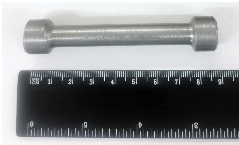
Рисунок 9 – Образец испытания на равноосное растяжение
