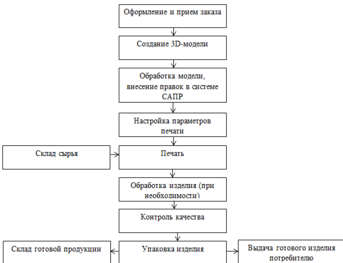
Рисунок 2.4 – Технологический процесс производства прототипов и прототипных форм
