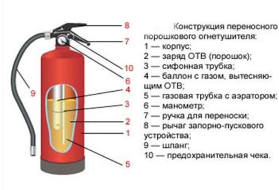
Рисунок 2.1 – Устройство порошкового огнетушителя
