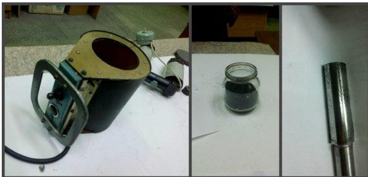
Рисунок 4. Намагничивание, магнитный порошок, отливка с микротрещинами.
