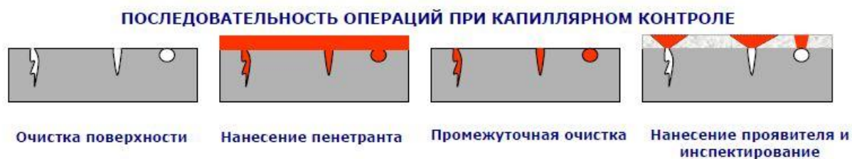
Рисунок 3. Последовательность операций при капиллярном контроле.
