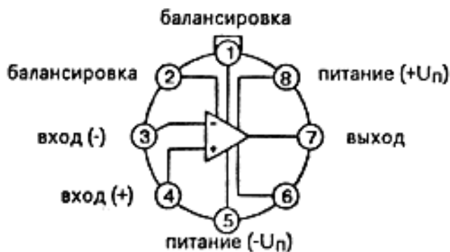
Рисунок 15 – Цоколевка корпуса 301.8-2 К140УД17
