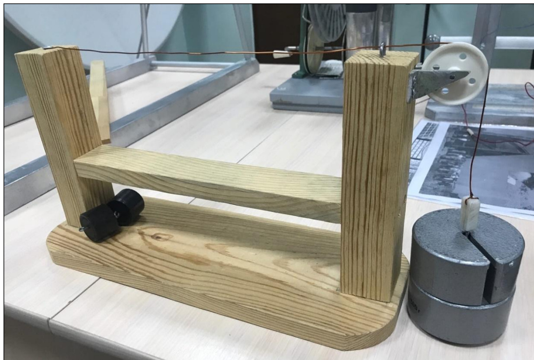
Рис .7. Интерактивный экспонат «Установка для демонстрации выигрыша в силе»
