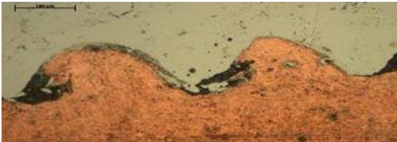
Рисунок 19 –Граница соединения между 12X18H10T и медью М1
