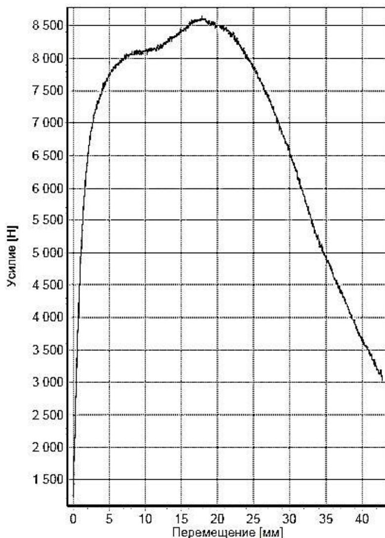
Рисунок 32 – График зависимости напряжения от относительного удлинения при статическом изгибе образца
