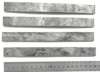
Рисунок 29 – Экспериментальные образцы композиционного металлического материала до проведения испытаний на статический изгиб
