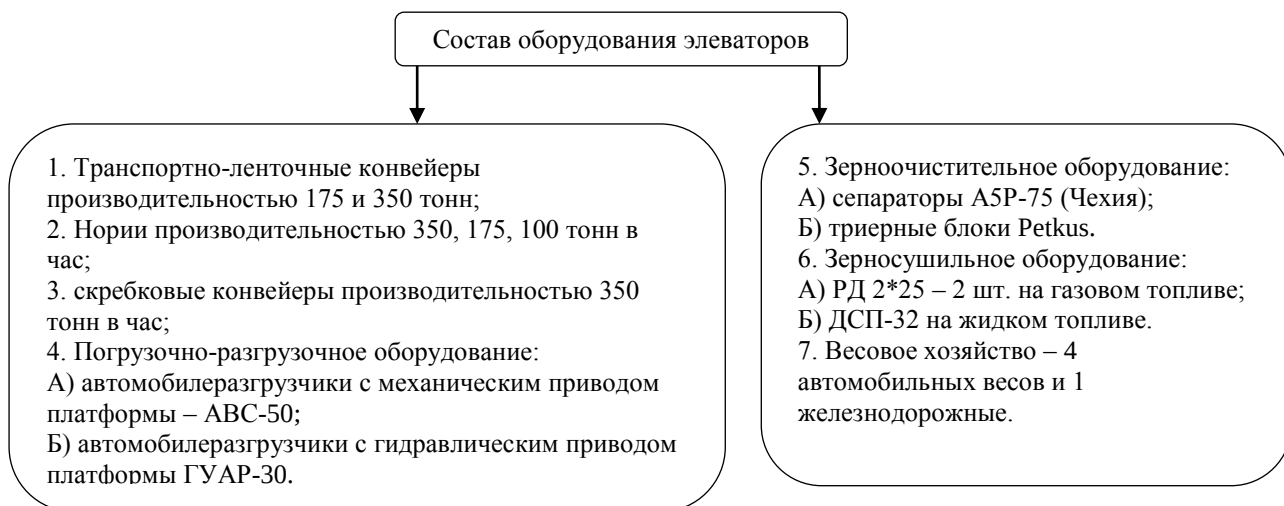
Рисунок 7 – Состав оборудования элеваторов
