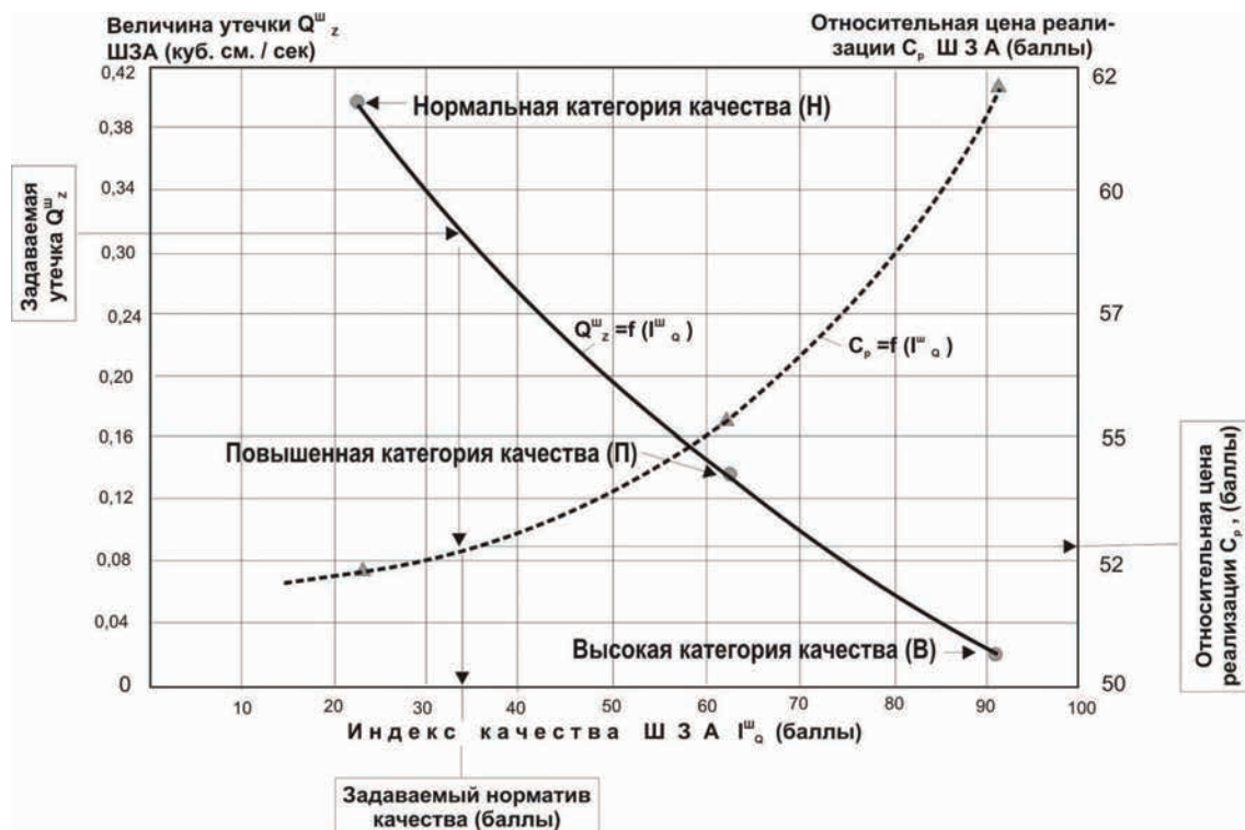
Рис. 6.18. Зависимость «протечка-качество-цена» для шаровой арматуры
