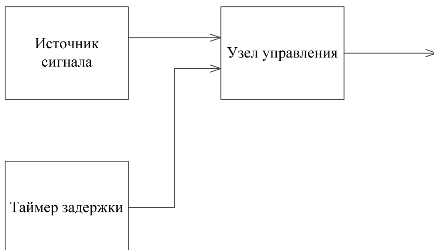
Рисунок 7 – Схема работы узла «антидребезг»
