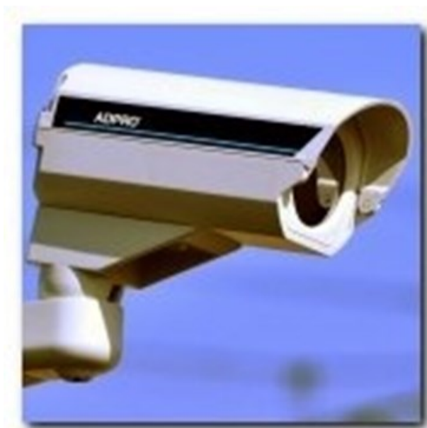
Рисунок 2.7 - Инфракрасный детектор транспорта
