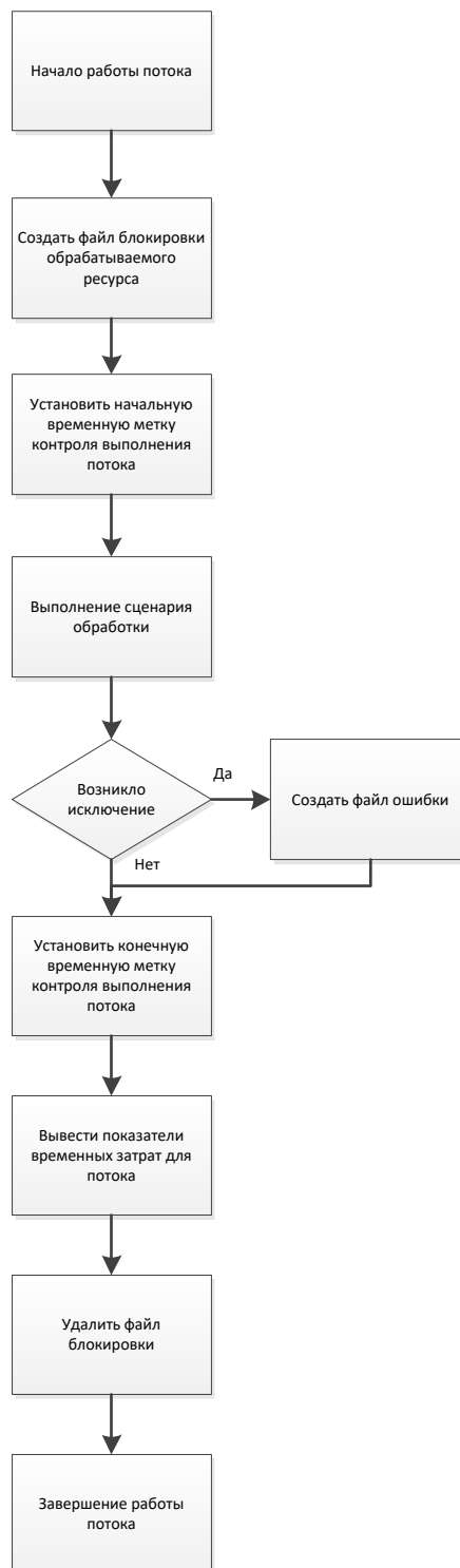
Рисунок 14 – Блок-схема работы потока микросервиса
