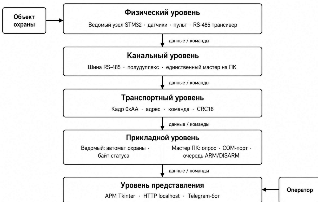
Рисунок 2.1 – Многоуровневая архитектура комплекса охранной сигнализации
