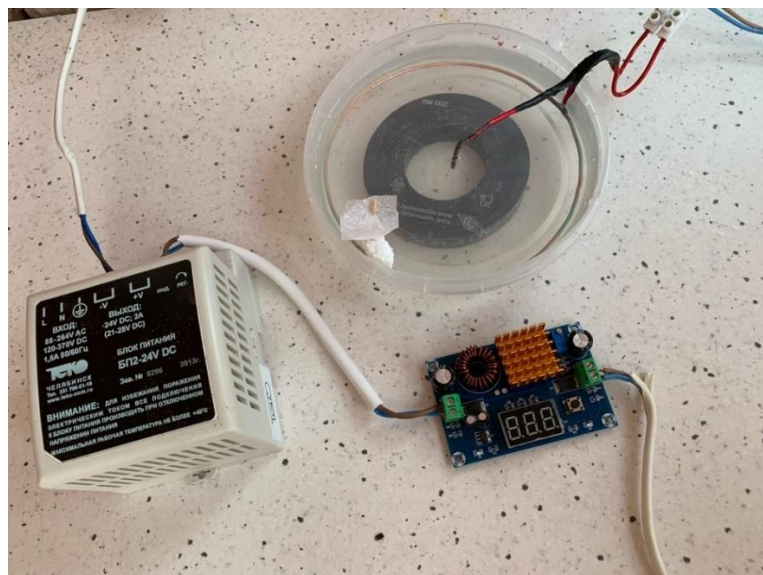
Рис. 2. Установка для демонстрации опыта «Движение заряженных частиц в магнитном и электрическом полях»
