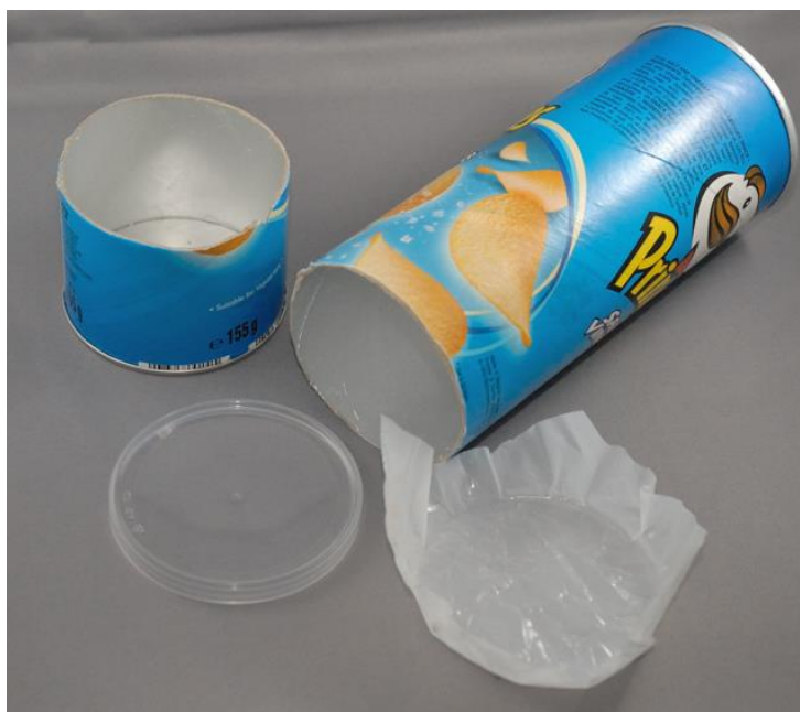
Рис. 4. Элементарная камера обскура
