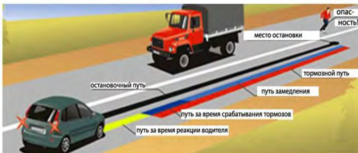
Рисунок 2.3 – Остановочный путь автомобиля и его составляющие
