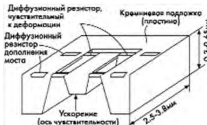
Рисунок 2.7 – Интегральный акселерометр объемной конструкции
