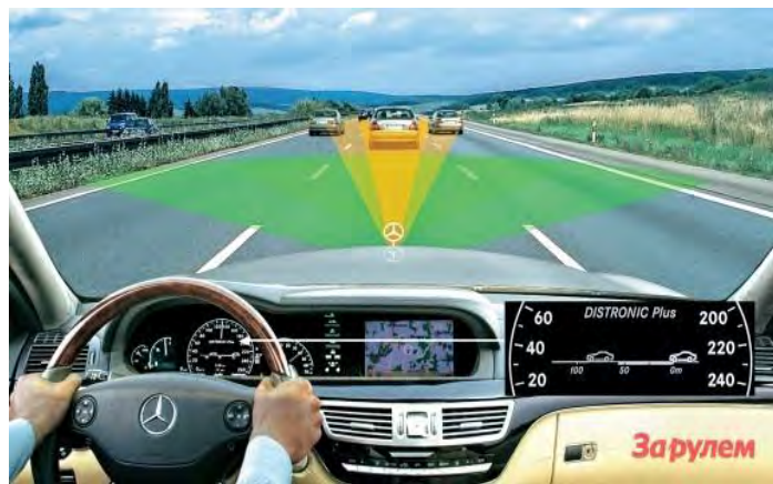
Рисунок 1.4 – Система адаптивного круиз-контроля
