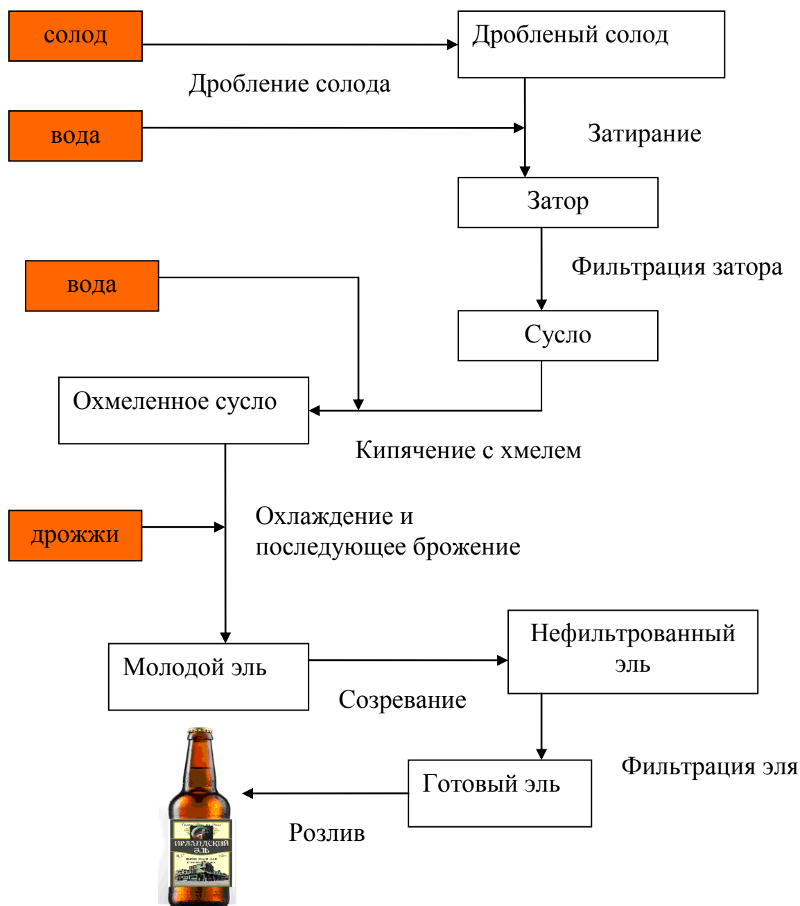
Рисунок 2.2 – Основные этапы технологического процесса производства эля
