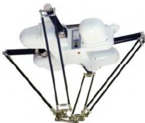
Рисунок 14 – Компоновка робота параллельного типа
