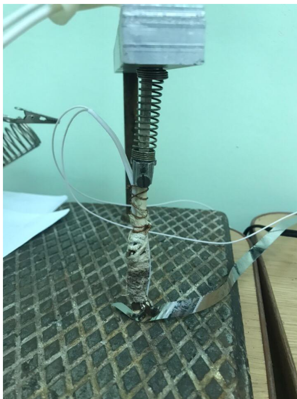
Рисунок 11 – Общий вид установки для исследования проволок и фольг, лент
