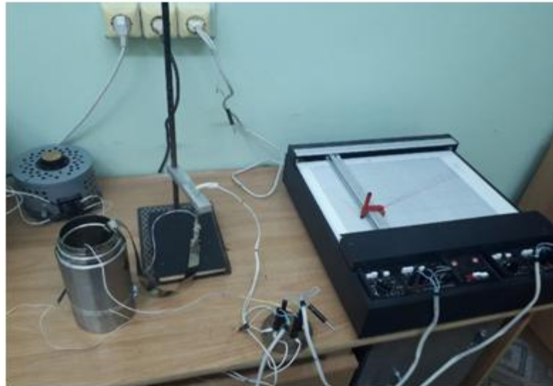
Рисунок 4 - Общий вид установки для измерения термо-ЭДС
