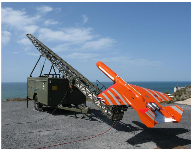
Рис. 10. Запуск беспилотного летательного аппарата с помощью катапульти
