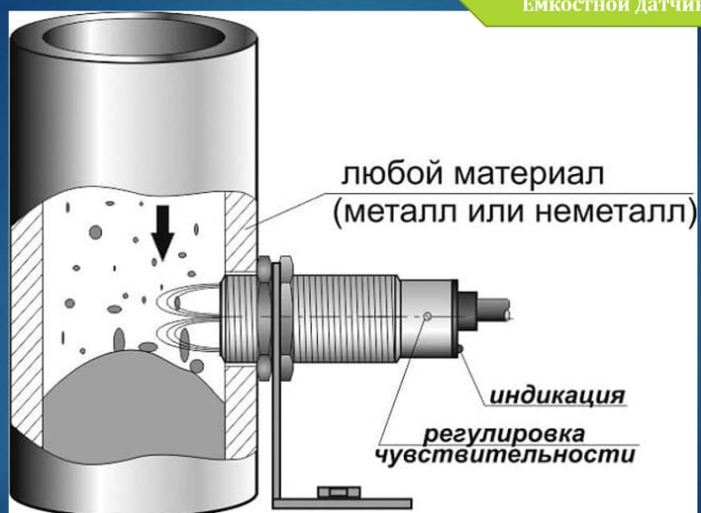
Емкостной датчик.
