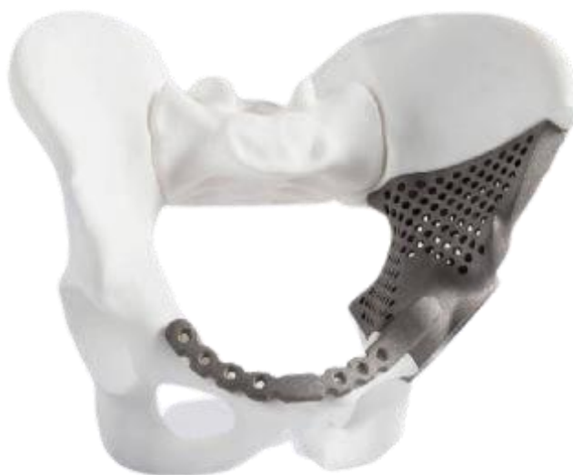
Рисунок 2.5 – Индивидуальный титановый имплантат для замены кости таза при онкологическом поражении
