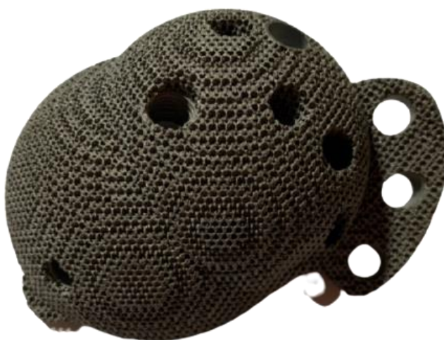
Рисунок 2.4 – Индивидуальный вертлужный компонент для ревизионного эндопротезирования тазобедренного сустава
