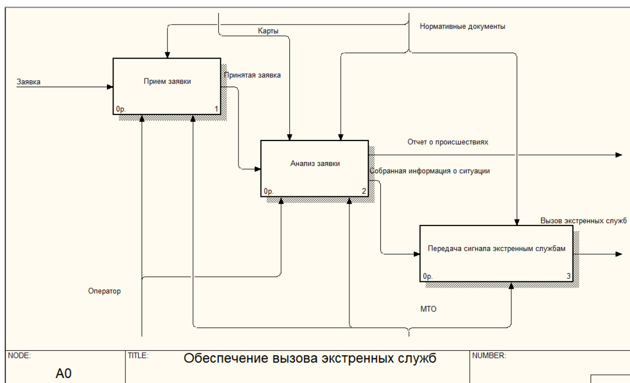
Рисунок 5 – Детализирующая диаграмма процесса «Обеспечение вызова экстренных служб» в нотации IDEF0
