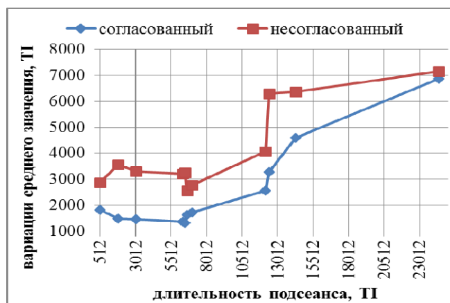
Рисунок 10 – График зависимости вариации среднего значения джиттера от длительности подсеанса при алгоритме DRR-TSS
