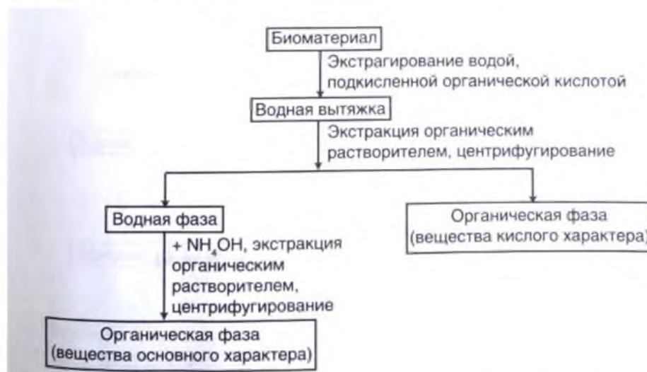
Рисунок 2. Изолирование веществ по методу А.А. Васильевой
