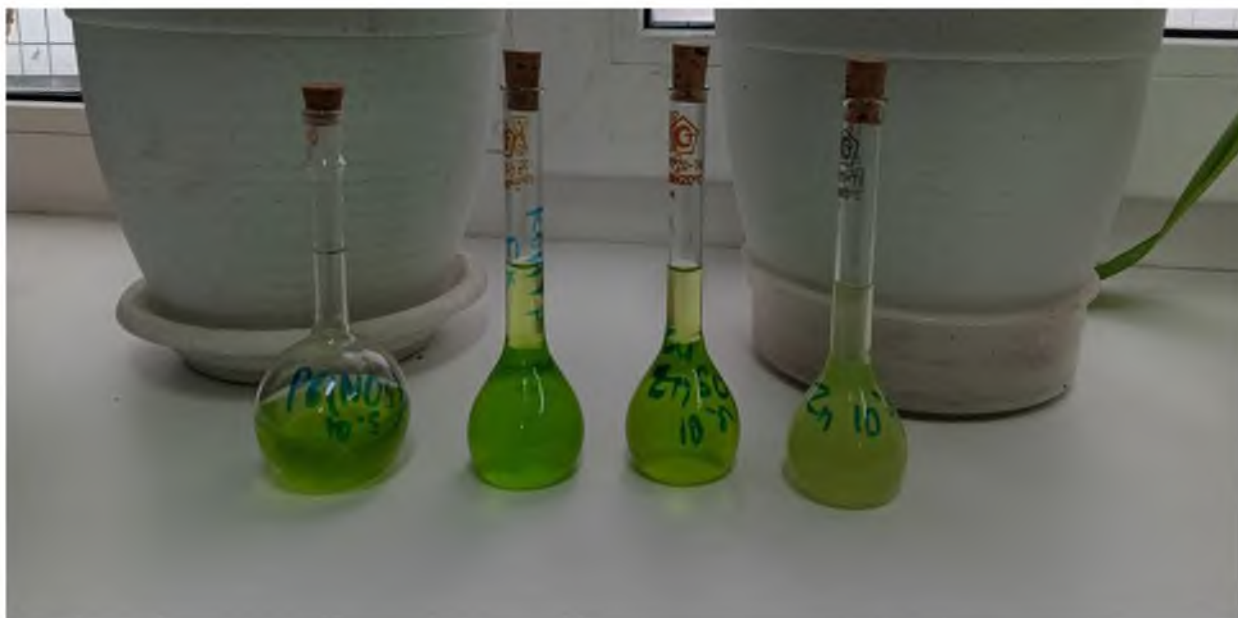
Рисунок 2. Ацетоновая вытяжка с суммой зеленых и желтых пигментов
