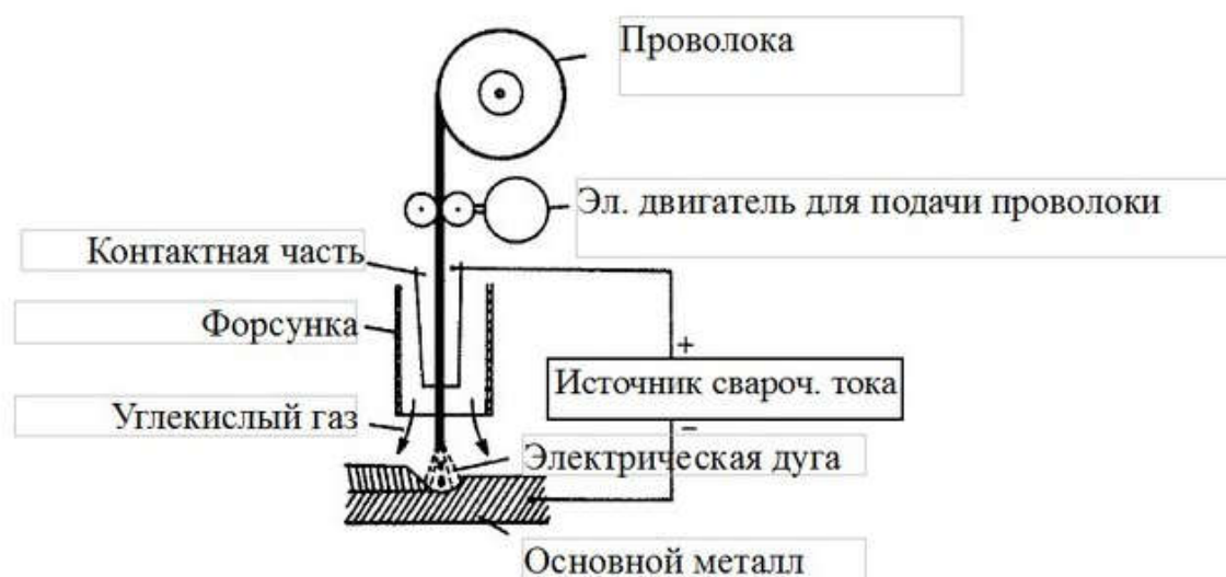
Рисунок 4.12 – Сварка в углекислом газе плавящимся электродом
