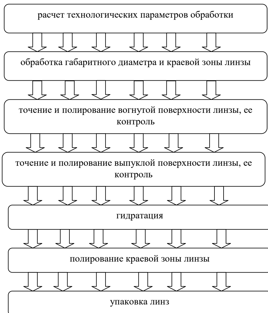
Рисунок 2.1 – Технологический процесс производства мягких контактных линз
