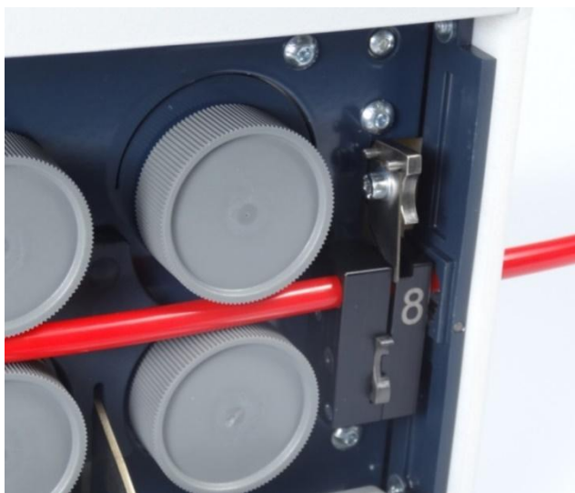
Рисунок 1.6 – Система протяжки трубки, нож и сменные направляющие
