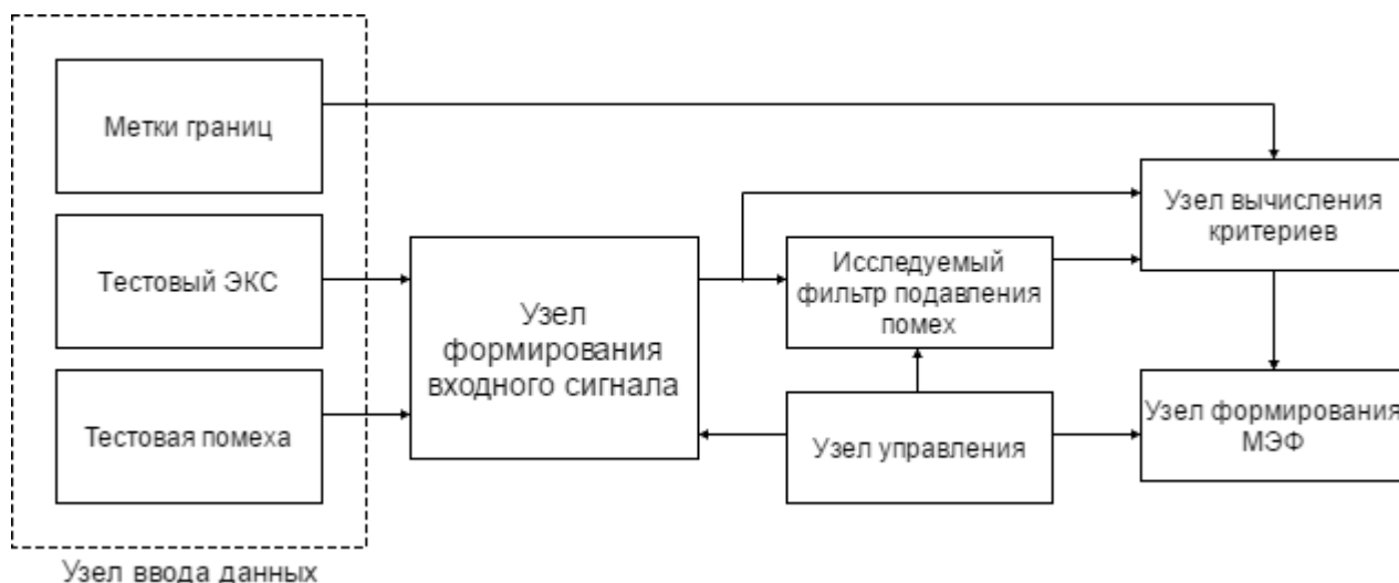
Рисунок 2.3– Структура системы тестирования алгоритмов подавления помех
