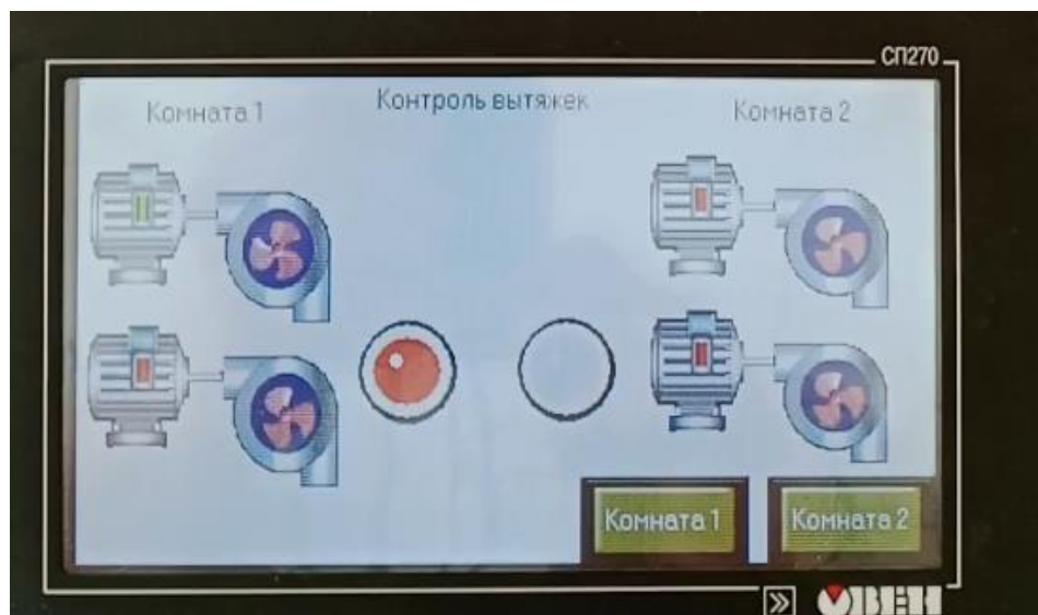
Рисунок 87 – Работа одной из вытяжек в Комнате 1
