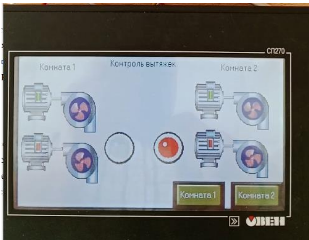
Рисунок 93– Работа одной вытяжки в Комнате 1
