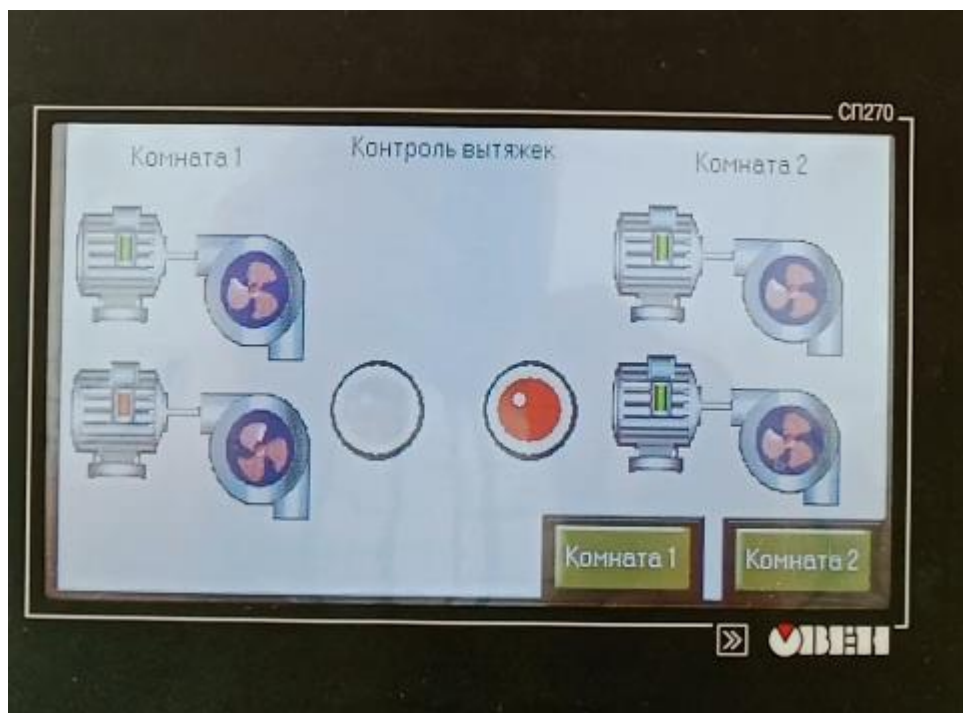
Рисунок 91– Работа всех вытяжек в Комнате 2
