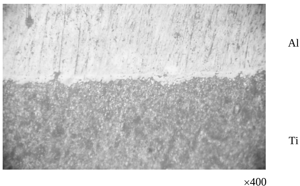
Рисунок 1.10 – Микроструктура зоны соединения при отжиге в течение 360 минут при температуре 550 °С
