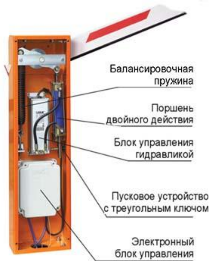
Рисунок 12. Исполнительные механизмы шлагбаума.
