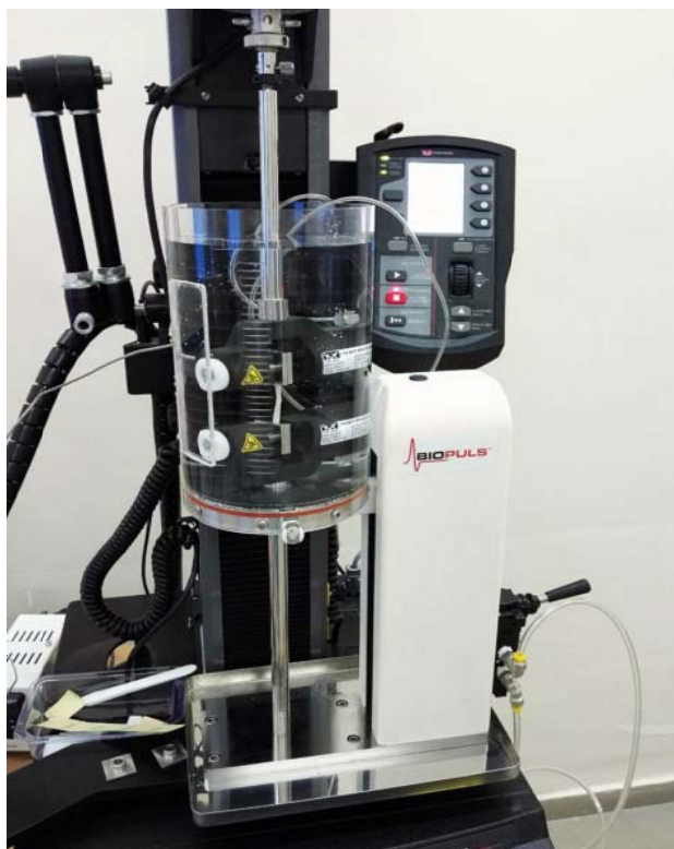
Рисунок 2. Испытательная установка INSTRON-5944 BIO PULS
