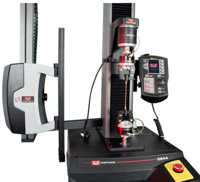
Рисунок 2. Испытательная установка INSTRON-5944 BIO PULS
