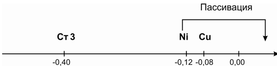
Рис. 5. Схема, иллюстрирующая соотношение потенциалов углеродистой стали (Ст 3), никеля и меди
