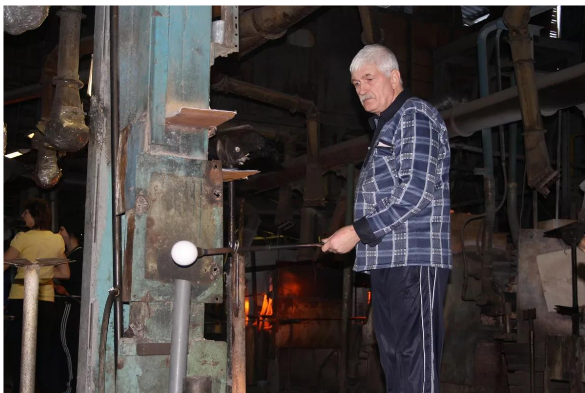
Рисунок 6 – Выдувка стекла на ЗАО «Никольский завод светотехнического стекла»
