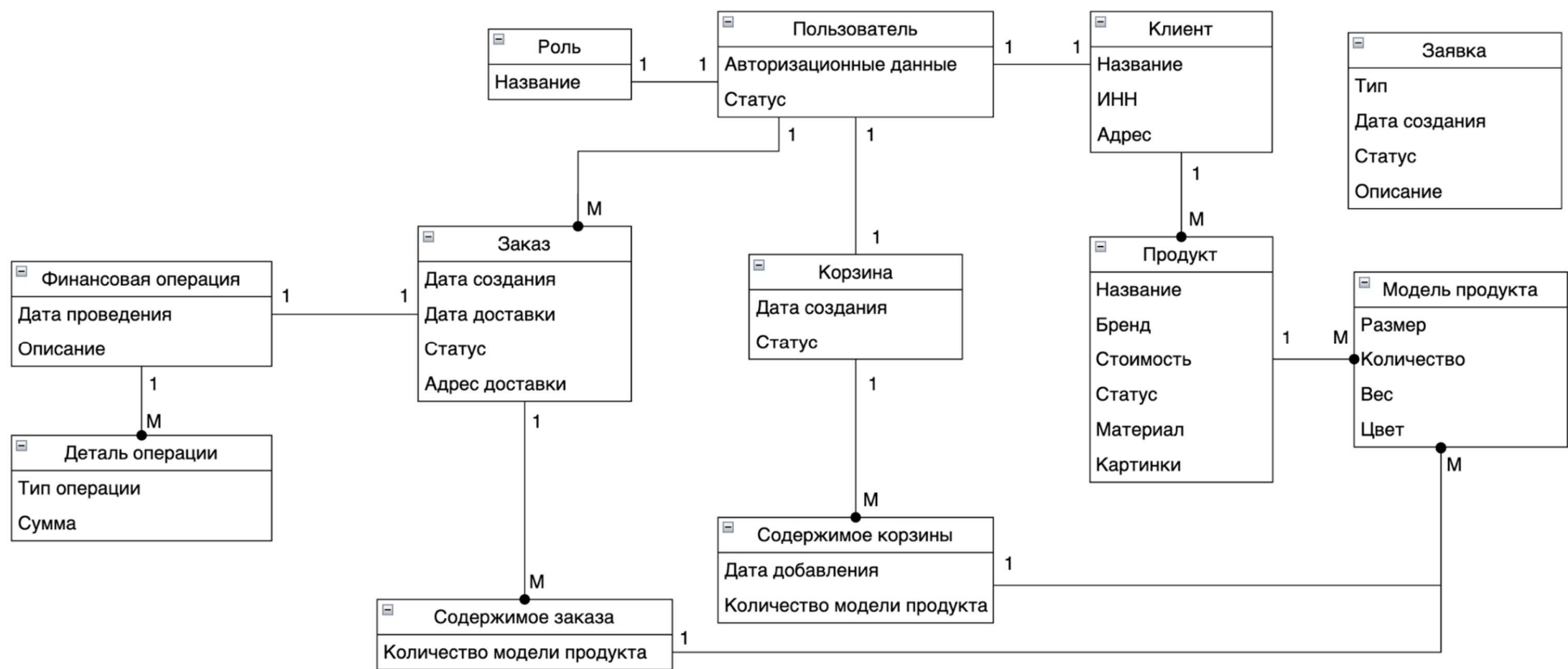
Рисунок 6 – Диаграмма «сущность-связь» концептуальной модели базы данных
