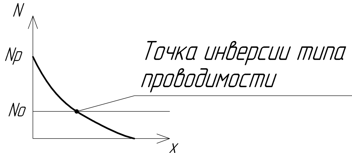
Рисунок 3.2 – Точка инверсии в полупроводнике
