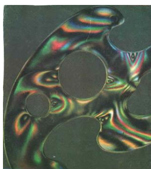
Рисунок 24. Внутреннее напряжение в детали
